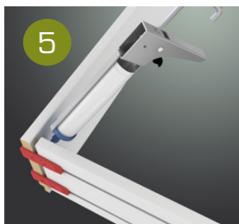
Endene påføres G-Fix limfugemasse før rammen presses helt sammen.
